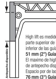
High lift es medido de la distancia de la parte superior de la puerta hasta el punto inferior de las guías horizontales.
