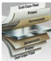
Acero galvanizado por inmersión caliente, pintado por imprimación para crear fuerza y producir la puerta más resistente a la corrosión
